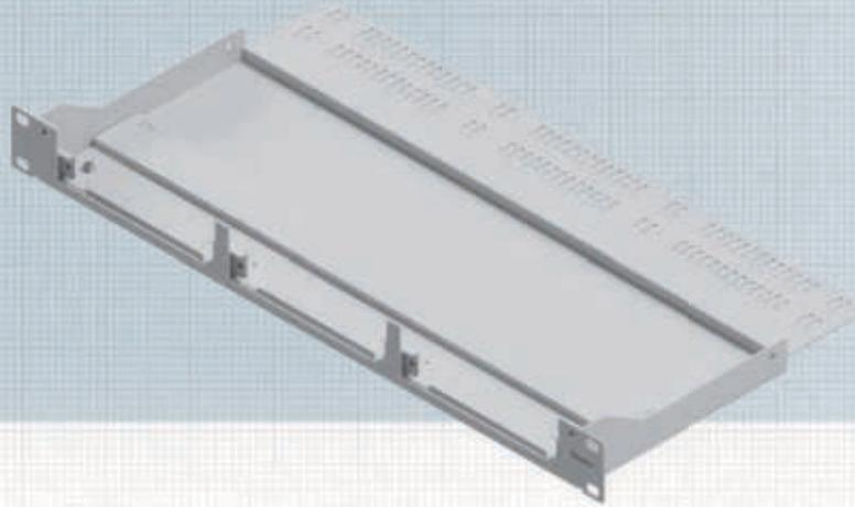
Modulträger (BGT) für den Einsatz von 7TE-Einschubmodulen in Kupfer und LWL. Sie werden über 2 Schrauben von der Panelseite am Modulträger fixiert. Die Einschubmodule lassen sich komplett aus dem Modulträger herausziehen. Es können maximal 3x 7TE-Einschubmodule (=18 Ports) im Modulträger befestigt werden.
