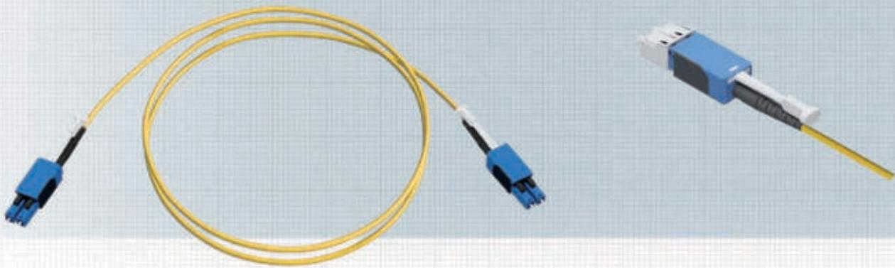
Das LC-Uniboot-Duplex Patch- und Adapterkabel ist durch die Verwendung von extrem schlanken Duplex Rundkabeln (Außendurchmesser 2,1 mm) besonders in Rechenzentren für High Density Anwendungen geeignet. Der LC Duplex Uniboot Stecker ist ein Steckverbinder für 2 Fasern mit einer Markierung für den aktuellen Polaritätsstatus. Die Änderung der Polarität ist dabei jederzeit möglich. Durch einen integrierten PushPull Tab kann der Stecker auch bei einem vollen Patchfeld problemlos demontiert werden.
