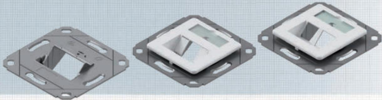
Die designfähige Modulaufnahme besteht aus einem Zinkdruckguss-Rahmen. Sie eignet sich für den Einbau in einen Kabelkanal (EK), für Unterputzmontage (UP) oder mittels separatem Rahmen auch zur Aufputzmontage (AP). Durch das Wegbrechen von zwei Montagelaschen ist auch eine Bodentankmontage (BT) möglich. Die designfähige Datendose ist mit nahezu allen am Markt erhältlichen Schalterprogrammen kombinierbar.
