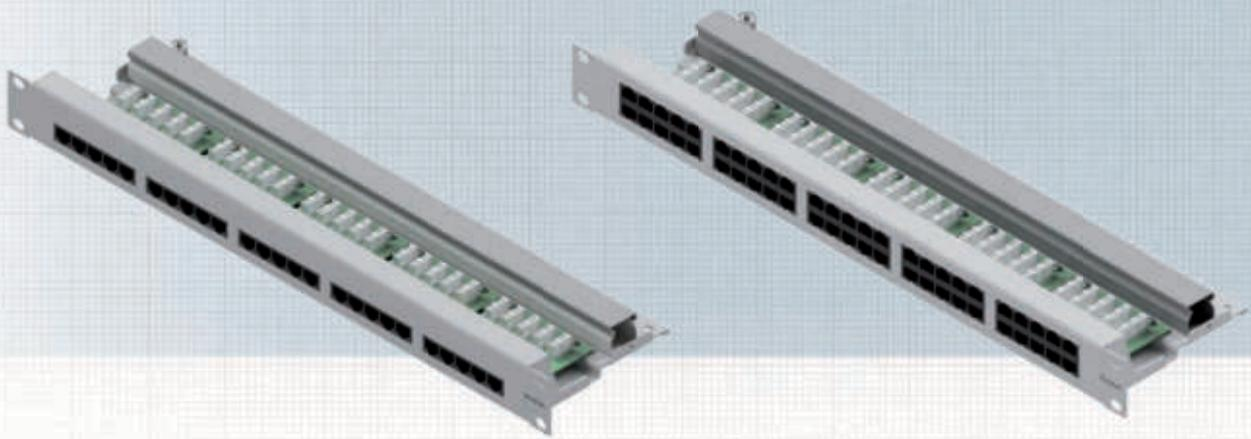
Verteilerfeld für die Übertragung von analogen und digitalen (ISDN) Telefonsignalen. Leistungsmerkmale entsprechend Klasse C nach ISO/IEC 11801-2002 und EN50173-2002. Für die saubere und übersichtliche Aderführung sorgt ein geschlitzter Kunststoff-Kabelkanal. Es können Telefonkabel bis 50 DA (25.4) bzw. 100 DA (50.4) an das Verteilerfeld angeschlossen werden.
